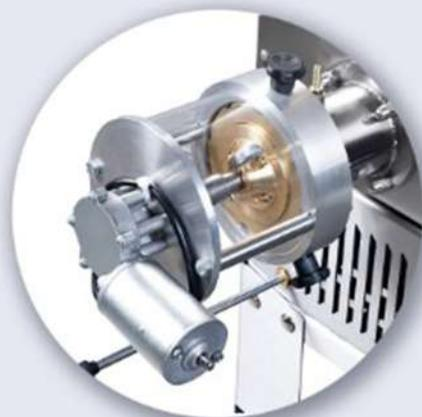
**Opcional:** dispositivo cortador automático com regulagem para até 10 níveis de velocidade.
