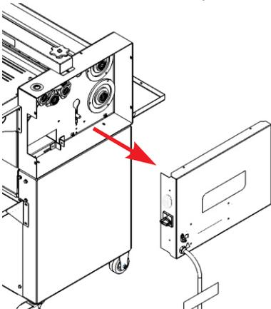
3 - Na lateral oposta, repita o processo e Remova a tampa lateral
