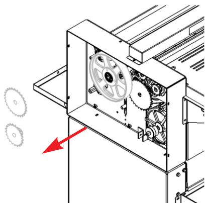
4 - Com o auxílio de uma chave phillips média, retire os parafusos dos eixos e remova-os
