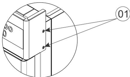
Para instalar a testeira que acompanha o equipamento é necessário afrouxa o (item 01) usando uma chave philips, não é necessário retirar os parafusos. Após afrouxados encaixe a testeira na posição e reaperte os parafusos.
