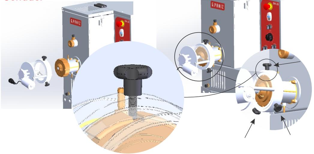
Posicione o cortador , conforme ilustrado na 1ª imagem acima, certifique-se que os manípulos para aperto encaixaram na porca, após isso de o aperto igualmente nos 3 manípulos.
